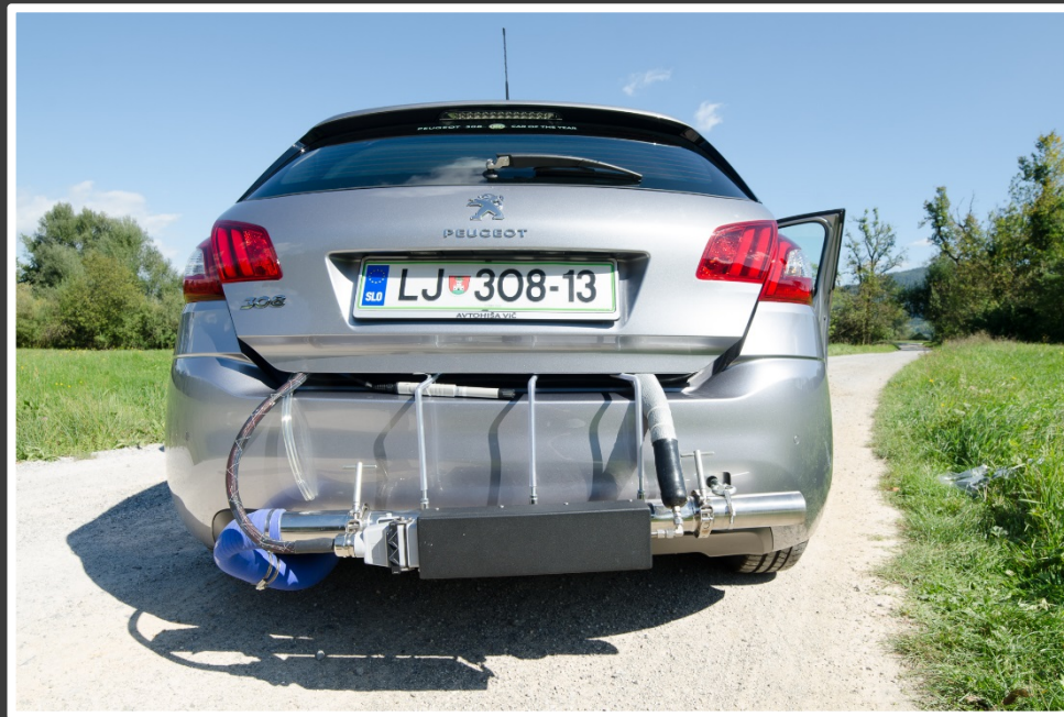
Merilnik masnega toka izpušnih plinov nameščen na zadek vozila.
